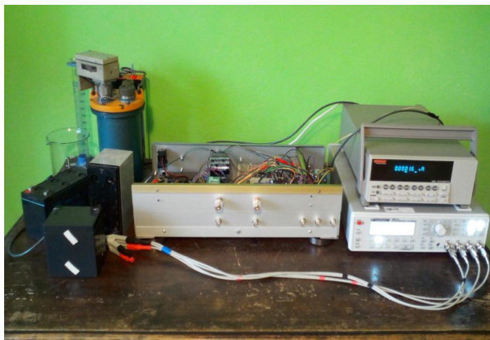
Rys. 1 Stanowisko badawcze do pomiarów impedancyjnych ogniw elektrochemicznych autor: Andrzej Nowrot
