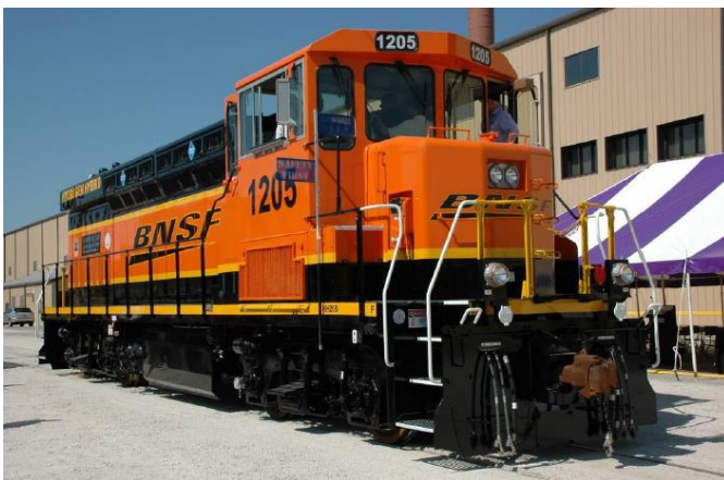
Rys. 1. Przykładowa realizacja manewrowej lokomotywy wodorowej. Źródło: Vehicle Projects Inc.
